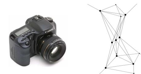
Abb. 5: Die als Sternkamera eingesetzte Canon EOS 10D. Grafische Darstellung der Mustererkennung.
